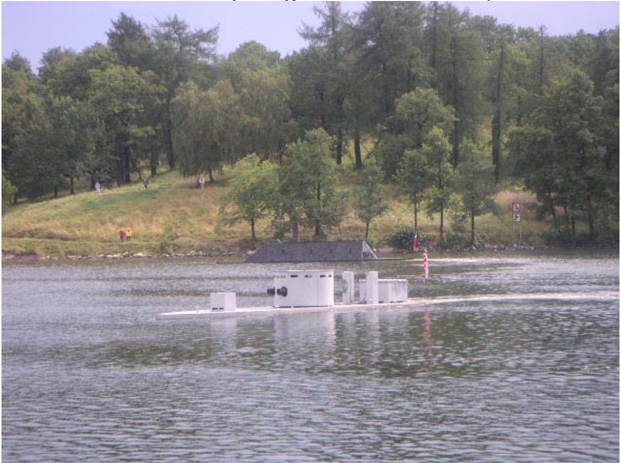
(John Ericssonsällskapetets kopia av Monitor. På originalet stack endast det runda kanontornet i mitten upp över vattenytan. De andra tornen på kopian är säkerhetsutrustning som det svenska Sjöfartsverket kräver).
